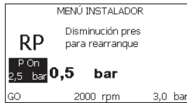
Figura 17: Configuración de la presión de reencendido
